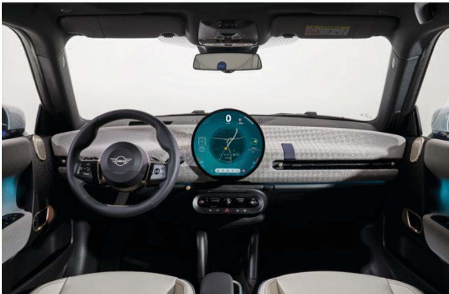
Pour la première fois, le tableau de bord incurvé aux dimensions généreuses présente des surfaces textiles. Un procédé de tricotage spécialement développé a été utilisé pour créer la structure polyvalente et facile à entretenir du textile dans un design bicolore en polyester recyclé.
